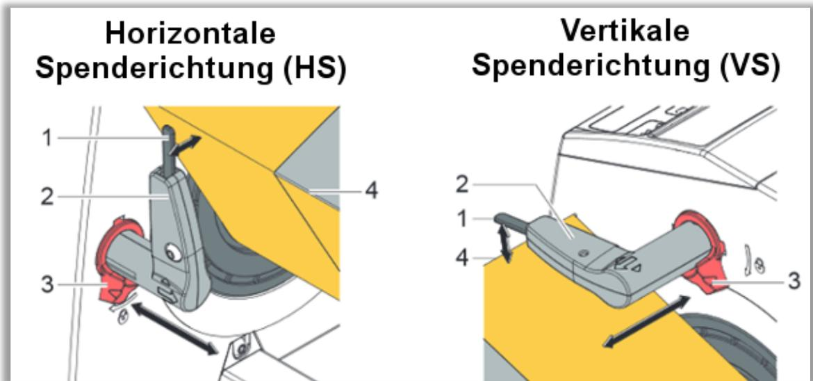
1. Durch Drehen des Stellknopfes (3) entgegen dem Uhrzeigersinn lösen Sie den Spendesensor (2).
