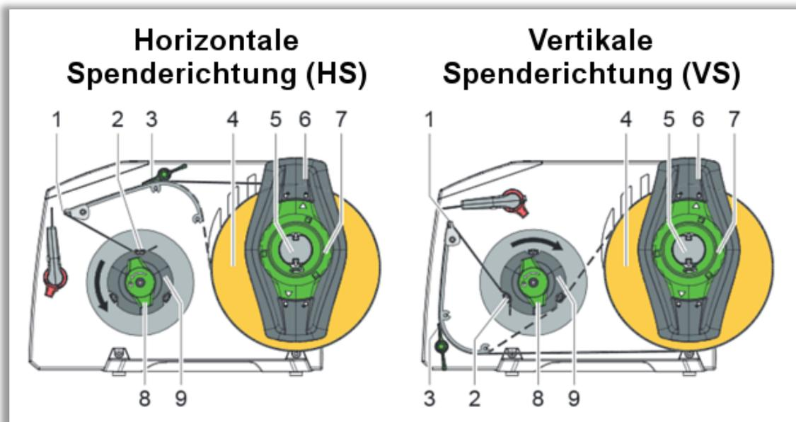
1. Zunächst ziehen Sie durch Drehen des Stellrings (7) den Randsteller (6) vom Rollenhalter (5) ab.
