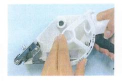
4 Schrauben Sie den Knopf mit dem Sensor ein wenig locker. Fixieren Sie den Sensor an der Mitte des Etiketts. Schrauben Sie den Knopf wieder fest.
